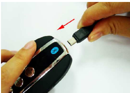
Mini USB Anschluss in den Bluetooth Upgrade Anschluss
