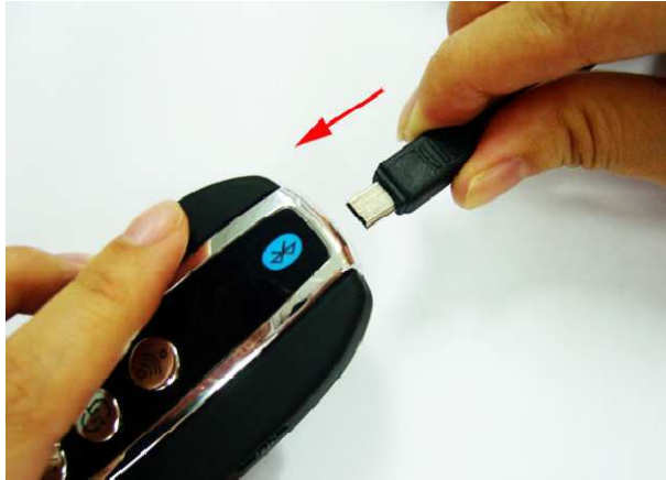
Stecken Sie den Mini USB Anschluss in den Bluetooth Upgrade Anschluss
